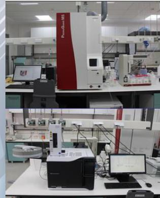
Analyse et quantification des traces des éléments inorganiques par spectrométrie plasma à coupleage inductif couplée à la spectrométrie de masse (ICP-MS)
