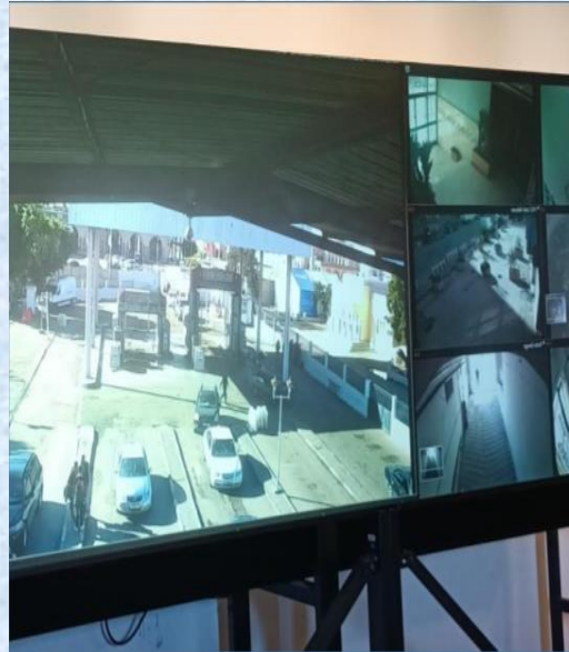
Système de vidéo surveillance et de contrôle d'accès au niveau des portes d'entrées / sorties des ports de Rades et de la Goulette (technologie ANPR et ACCR avec barrière de sécurité)
